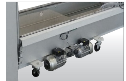
Integrierte Transportrollen zum einfachen Bewegen.
