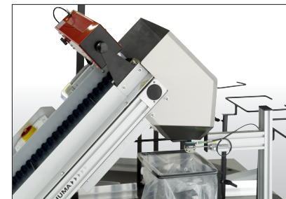
Befüllung über ein SCHUMA Förderband mit Ionisierung.
